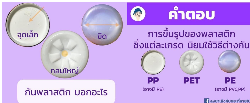
ภาพที่ 3 จุดสังเกตประเภทพลาสติกตามการขึ้นรูป
