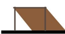
มีแผงหลังคากระนาบเดียว เป็นหลังคาทรงเพิงหมาแหงน
